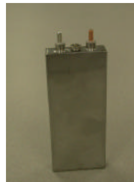
Fig. 7. Li Ion Polymer Test Cell
