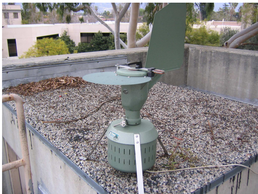
Figura 2: Dispositivo Burkard utilizzato per la raccolta di pollini nell'aria.
