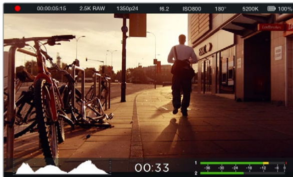
Blackmagic Cinema Cameraのオンスクリーン・メーターとステータス・ストリップ。スクリーンを下から上にスワイプするとメーターディスプレイが表示されます。
