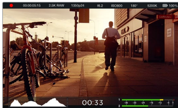
Экранная индикация и строка состояния на Blackmagic Cinema Camera. Проведите пальцем по экрану снизу вверх, чтобы открыть индикаторы.
