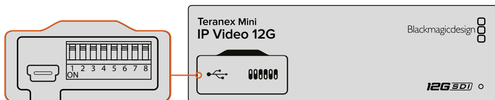
Настройку переключателя 1 меняют с помощью авторучки
