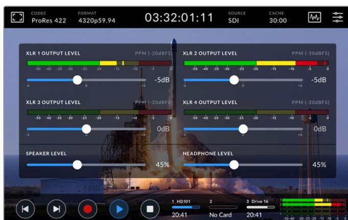
音频表将会把您当前的音频通过VU或PPM音频监看显示。禁用的音频轨道显示为灰色
