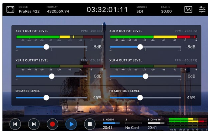
Индикаторы звука показывают уровень громкости по шкале VU или PPM. Каналы, которые отключены, недоступны для регулировки.
