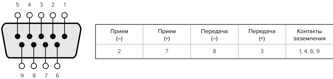
Схема расписки для дистанционного управления по протоколу RS-422
