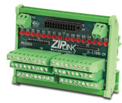
ZL-LTB16-24 sensor input module
