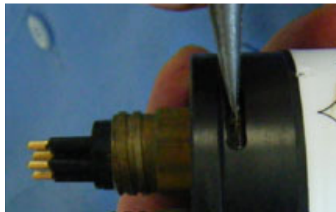
Abbildung 1 Monofilament aus dem Endflansch ziehen
