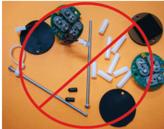
Figure 2 Résultat du retrait des deux vis de fixation
